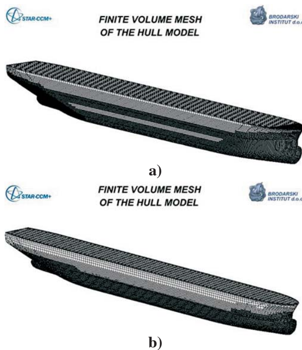
Figure 2 Finite volume mesh of the tanker model; a – design draught, b – ballast draught Slika 2 Mreža konačnih volumena modela tankera; a – projektni gaz, b – balastni gaz
