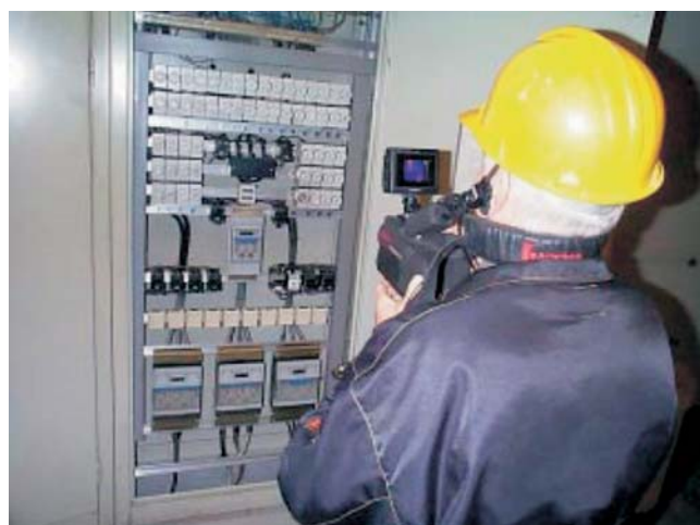
Figure 6 Using a hand held thermovision camera on board ship Slika 6 Uporaba ručne termovizijske kamere na razvodnoj ploči broda
