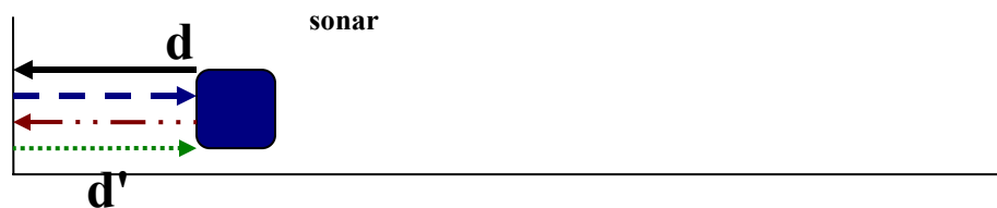
Slika 5.3 Neželjena refleksija od ronilice
